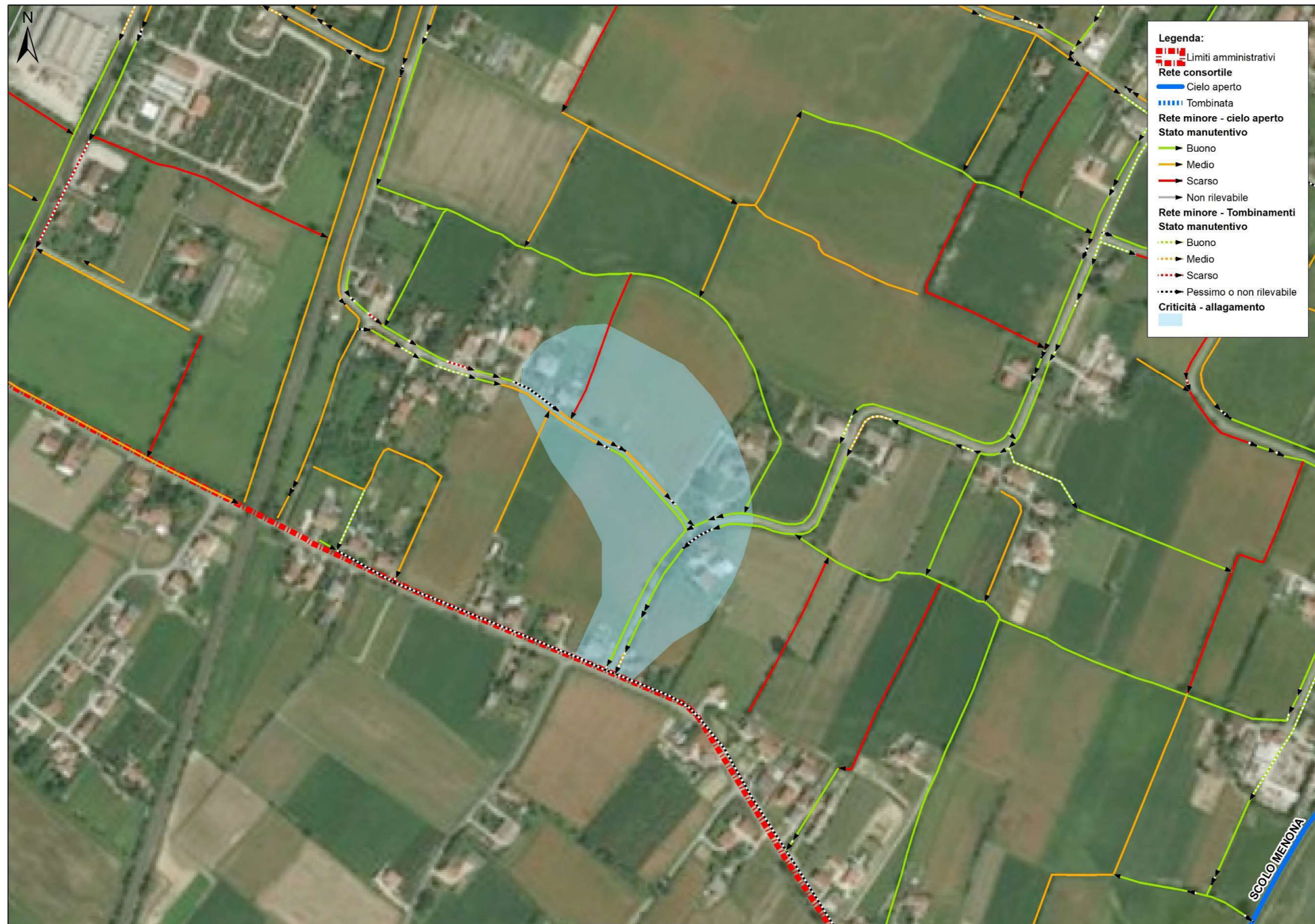
Immagine 4.2: Planimetria stato manutentivo della rete dei fossi limitrofi via Giarre e via Levante Ferrovia ante realizzazione intervento
