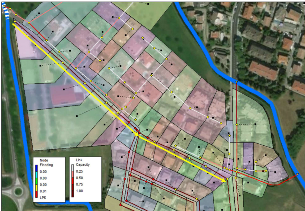
Immagine 2.17: Rappresentazione profili idraulici dei risultati di modello Rete via Montegrotto ovest-est lato sud - SDF
