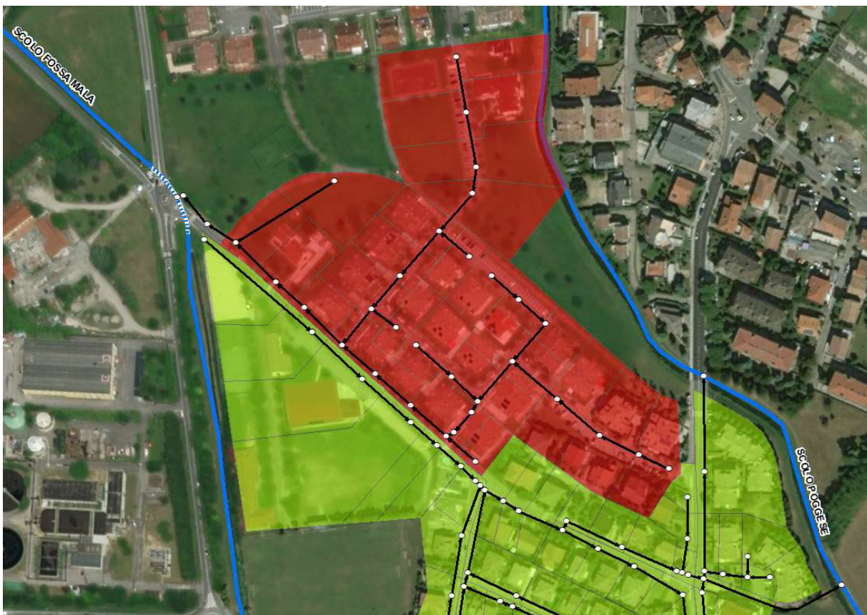
Immagine 2.2: Planimetria stato di fatto rete di fognatura a servizio dell'area a nord di via Montegrotto
