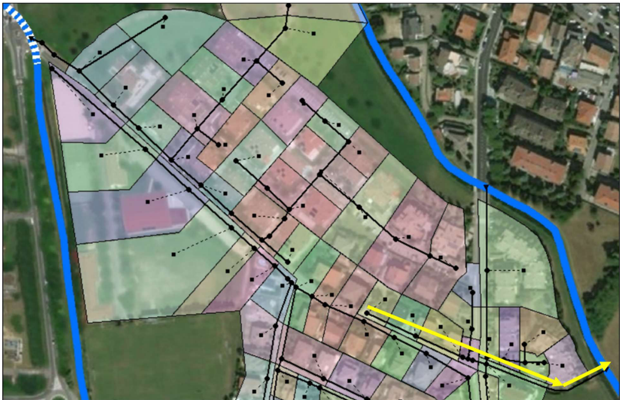
Immagine 2.14: Rappresentazione del profilo della rete ovest-est lato nord di via Montegrotto fino allo scarico in scolo Poggese - SDF
