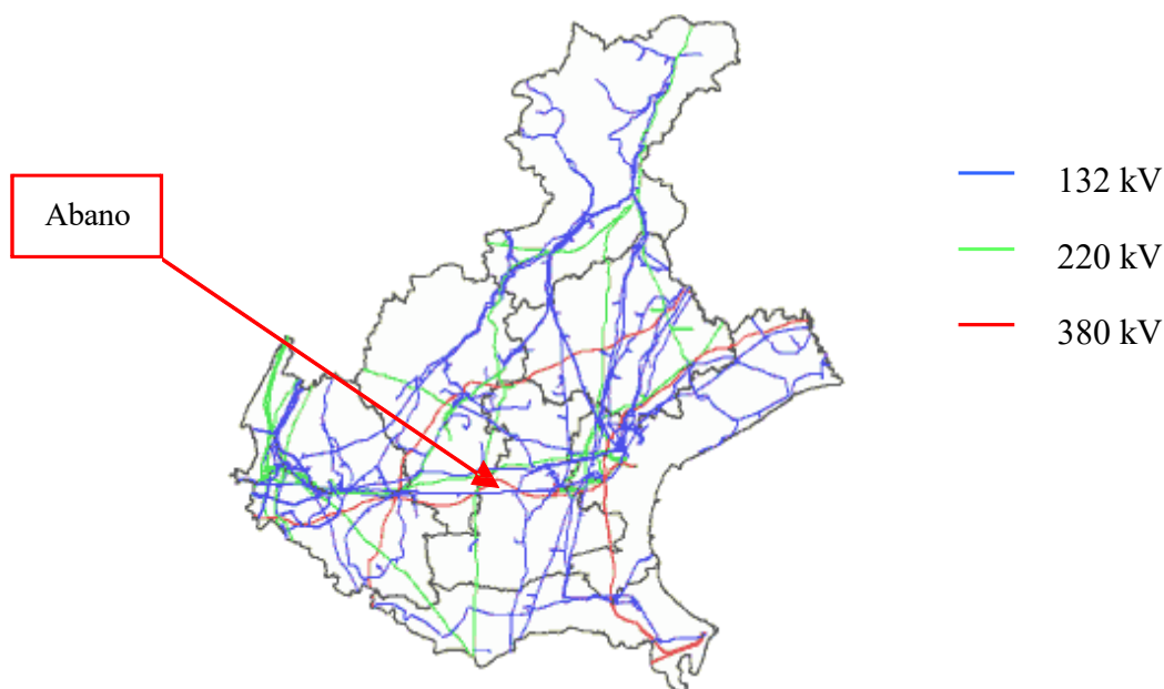
Figura 85: Localizzazione delle linee elettriche ad alta tensione in Veneto
