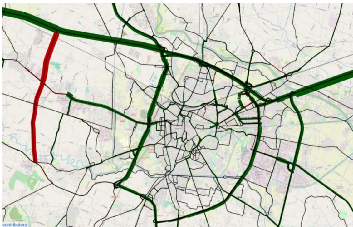
Fig. 9.11: Flussogramma 35 delle differenze dei flussi tra lo Scenario PUMS 2030 e lo Scenario attuale (veicoli nell'ora di punta del mattino – giorno feriale medio invernale)
