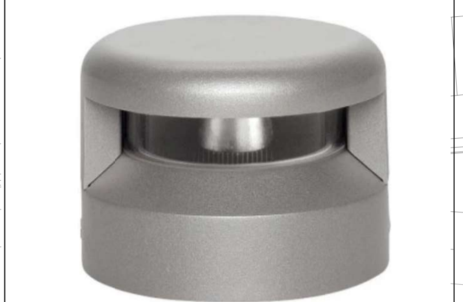
Corpo illuminante di tipo bollard, potenza 10 W, flusso luminoso 380 lm, con distribuzione asimmetrica radiale di 180°, dimensioni a 130 mm altezza 96 mm. tipo Joe cod. 59165N00 - marca Linea Light
