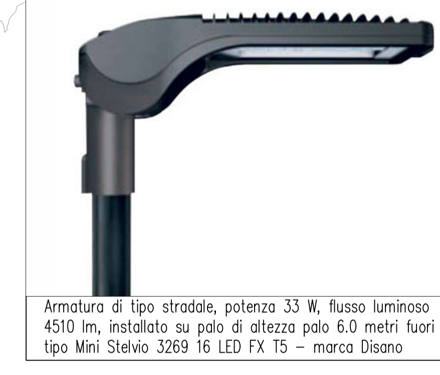
Armatura di tipo stradale, potenza 33 W, flusso luminoso 4510 lm, installato su palo di altezza palo 6.0 metri fuori terra, tipo Mini Stelvio 3269 16 LED FX T5 - marca Disamo
