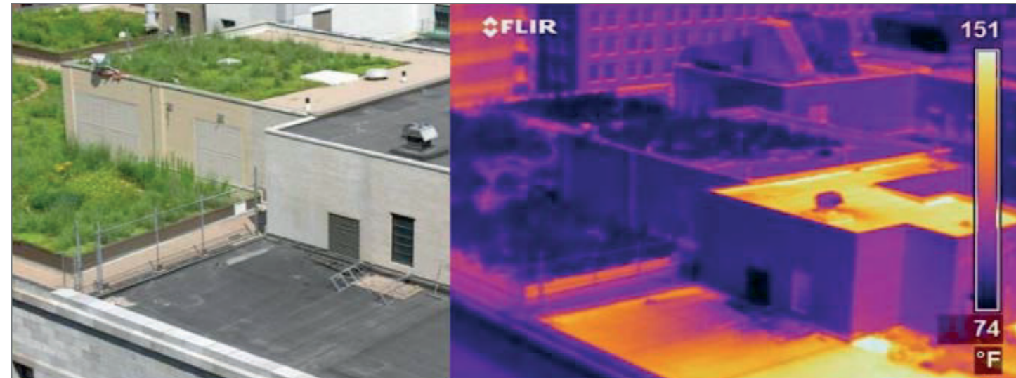
Abbattimento isola di calore: fotocamera termica
