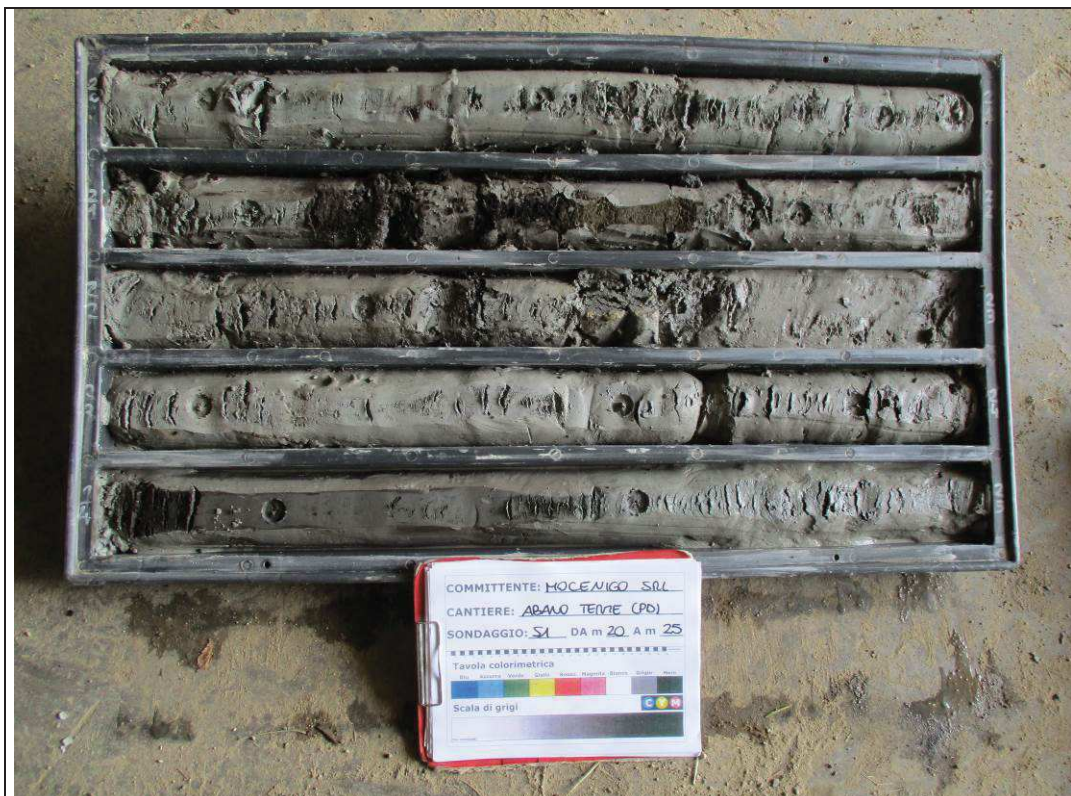
Sondaggio S1 – Cassetta N. 5 : da 20.0 m a 25.0 m
