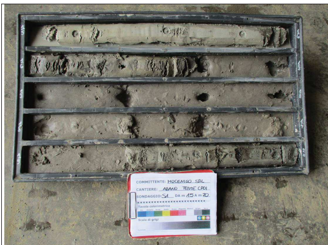
Sondaggio S1 – Cassetta N. 4 : da 15.0 m a 20.0 m
