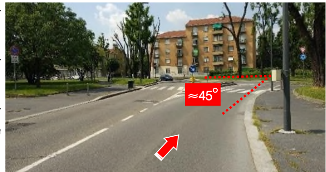
Figura 4.2 – Angolo di installazione dei radar rispetto alla direzione di marcia
