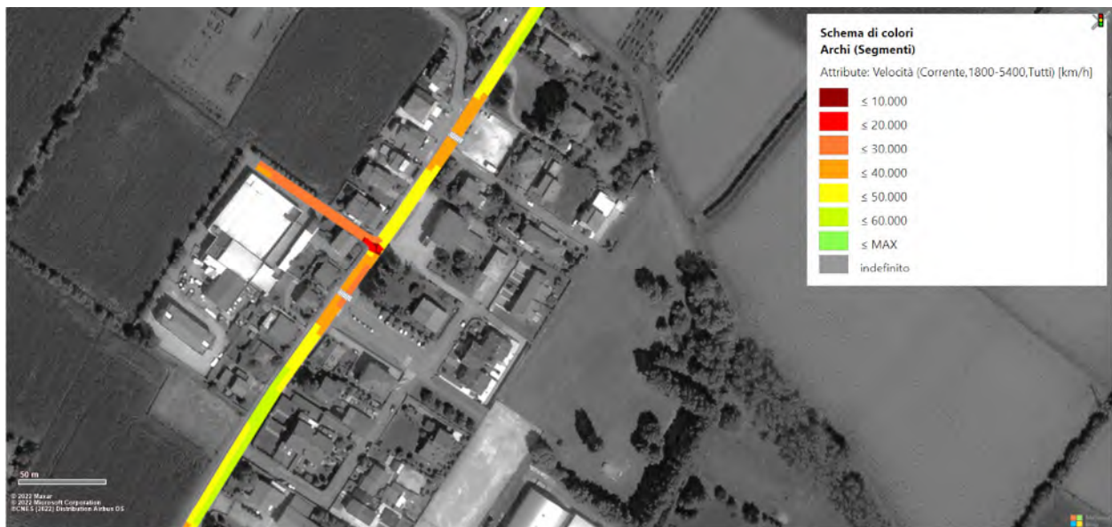
Figura 7.8 – Velocità media per arco stradale in corrispondenza degli accessi alla struttura – Scenario 0
