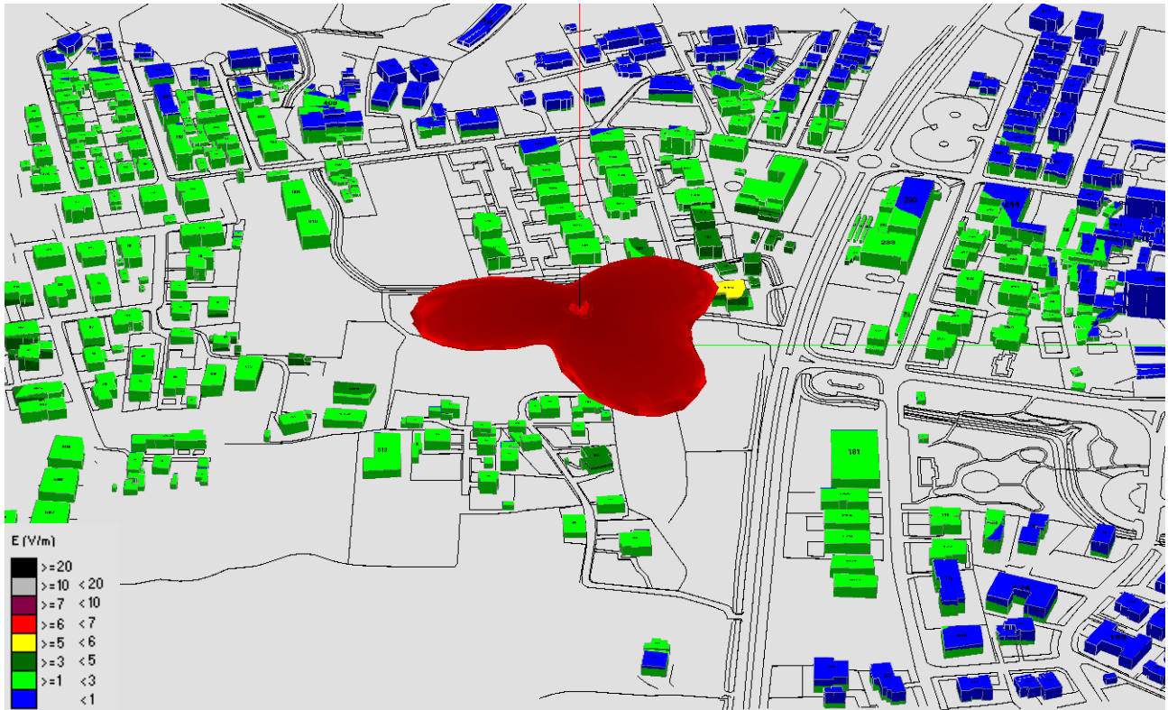
Fig. 52 Impatto elettromagnetico – Zona Via Monte Croce – 0°/Nord
