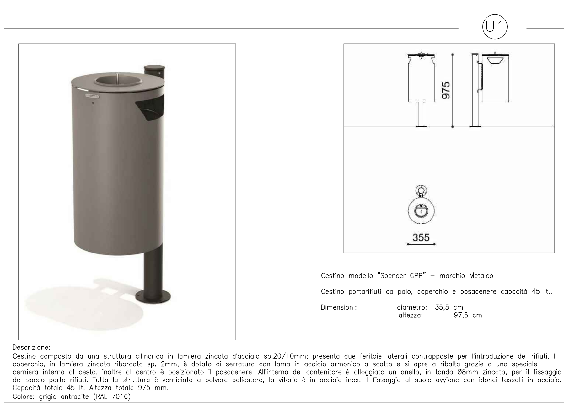
DESCRIZIONE: Cestino composto da una struttura cilindrica in lamiera zincata d'acciaio sp.20/10mm; presenta due feritoie laterali contrapposte per l'introduzione dei rifiuti. Il coperchio, in lamiera zincata ribordata sp. 2mm, è dotato di serratura con lama in acciaio armonico a scatto e si apre a ribalta grazie a una speciale cerniera interna al cesto, inoltre al centro è posizionato il posacenere. All'interno del contenitore è alloggiato un anello, in tondo Ø8mm zincato, per il fissaggio del sacco porta rifiuti. Tutta la struttura è verniciata a polvere poliestere, la viteria è in acciaio inox. Il fissaggio al suolo avviene con idonei tessili in acciaio. Capacità totale 45 lt. Altezza totale 975 mm. Colore: grigio antracite (RAL 7016)
