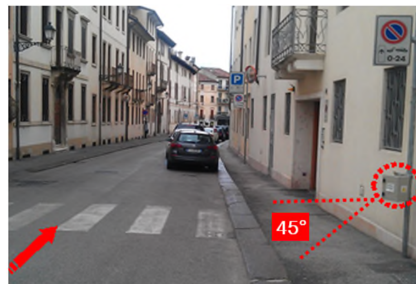
Figura 5.3 – Angolo di installazione dei radar rispetto alla direzione di marcia
