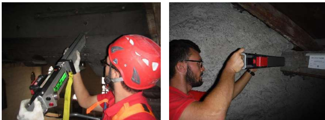
Figura 3.2: esecuzione della prova penetrometrica
